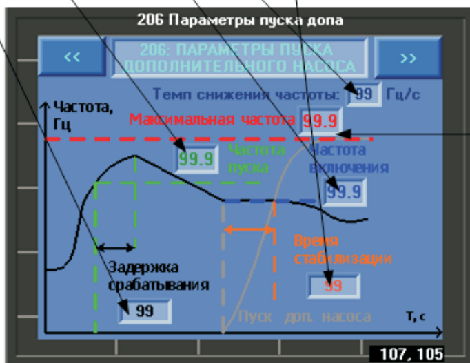
Черным условно показано изменение частоты насоса мастера, серым – дополнительного насоса, включаемого напрямую от сети
